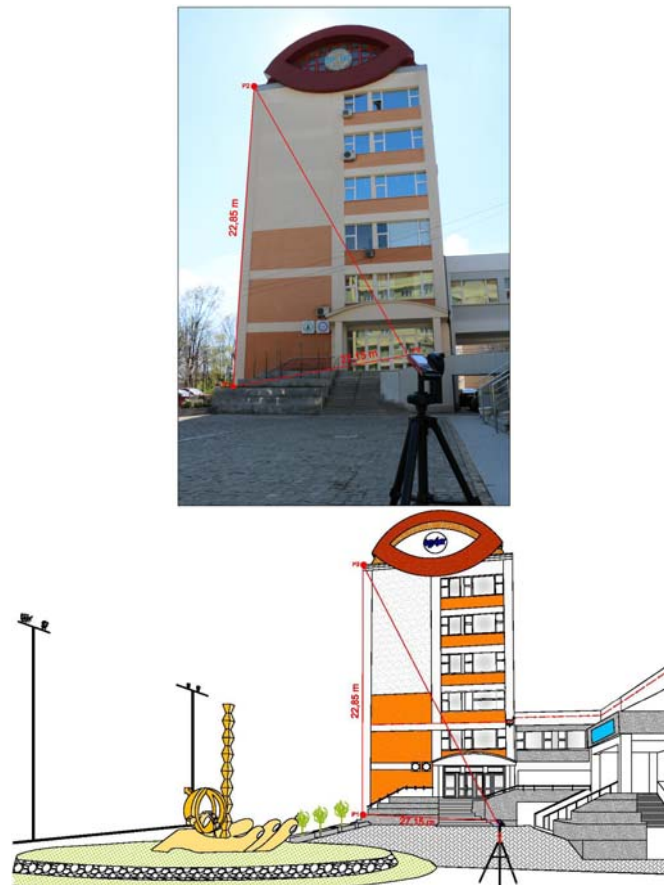
Fig. 11. Măsurarea distanței cu ajutorul funcției P2P
